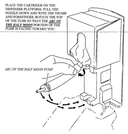
THEN PLACE THE TOP OF THE TUBE FIRMLY IN THE NECK OF THE UPPER LOCATOR AND FIT THE EARS OF THE HALF MOON PUMP IN THE SLOTS IN THE LOWER LOCATOR.
